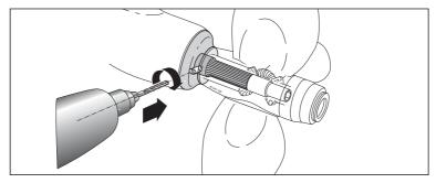
5 - Utiliser un foret de ø 6,5 mm pour créer une empreinte sur l'arbre en correspondance avec le logement de la vis de sécurité.
