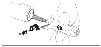
3 - Enlevez la vis ALEN de sécurité a l'aide de la clefs ALEN type et installer l'hélice sur l'arbre
