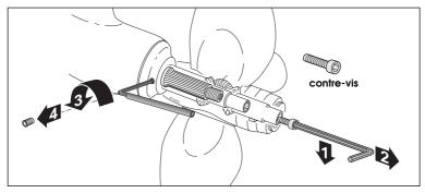
3 - incliner la clef ALEN et extraire la contre-vis. Inserer la clef ALEN type D dans la vis de sécurité, devisser (sens anti-horaire) à l'aide d'une rallonge métallique de longueur 15÷20 cm et extraire la vis.
