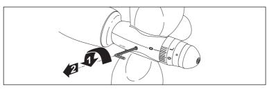
1 - dévisser le grain (vis ALEN) situé sous le point rouge (clef Type C, tableau 1, section 2).
