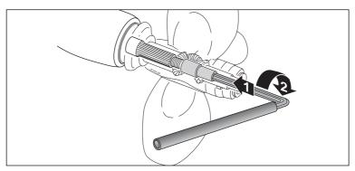
4 - visser l'écrou de l'hélice avec la clef ALEN Type A, en serrant fort avec l'aide d'un tube métallique d'une longueur de 20/30 cm.
