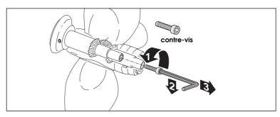
2 - introduire la clef ALEN Type B dans la contre-vis et la devisser (sens anti-horaire) jusqu'à ce qu'il soit complètement libre. Inclinez la clef ALEN et retirez le contre-vis.
