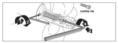
9 - Enduire les filetages de la vis de sécurité et de la contre-vis avec un liquide type "frein filet". Visser à fond la vis de sécurité à l'aide de la clefs ALEN type D et le contre-vis à l'aide de la clefs ALEN type B
