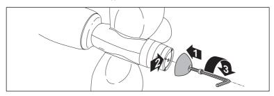
2 -Fixer la nouvelle anode en faisant attention à introduire le grain de ferme ( operation 2 ) dans le logement spécial sur le zinc.
