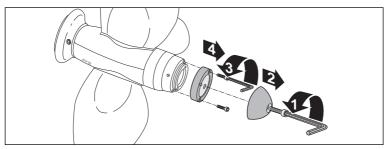
1 - enlever l'anode en zinc ( operation 1, clef ALEN Type B ) et le support en bronze ( operation 3, clef ALEN Type C ) voir tableau 1 - section 2.
