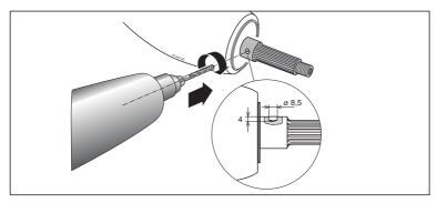
7 - A l'aide d'un foret de ø 8,5 mm percer (sur l'empreinte crée) un trou de 4 mm de profondeur.
