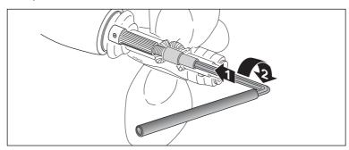
8 - Enduire le filetage de l'arbre de liquide type "frein filet" ; repositionner l'hélice sur l'arbre en alignant le logement de la vis de sécurité avec le trou crée puis visser la vis principale à l'aide de la clef ALEN type A. Serrer fortement à l'aide d'un tube rallonge de longueur 20 à 30 cm.
