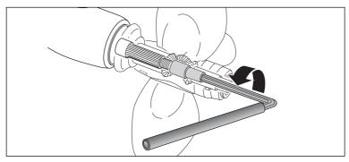
4 - introduire la clef ALEN Type A dans l'écrou et devisser (sens anti-horaire) avec l'aide d'un tube métallique de longueur 20/30 cm.
