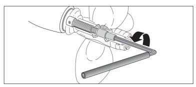
6 - introduire la clef ALEN Type A dans l'écrou principal et la devisser (sens anti-horaire) jusqu'à ce qu'il soit complètement libre. Quand l'écrou tourne à vide, désacoupler l'hélice de l'arbre.
