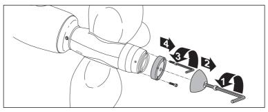
1 - enlever l'anode (operation 1, clef ALEN Type B) et le support en bronze (operation 3, clef ALEN Type C) voir tableau 1.
